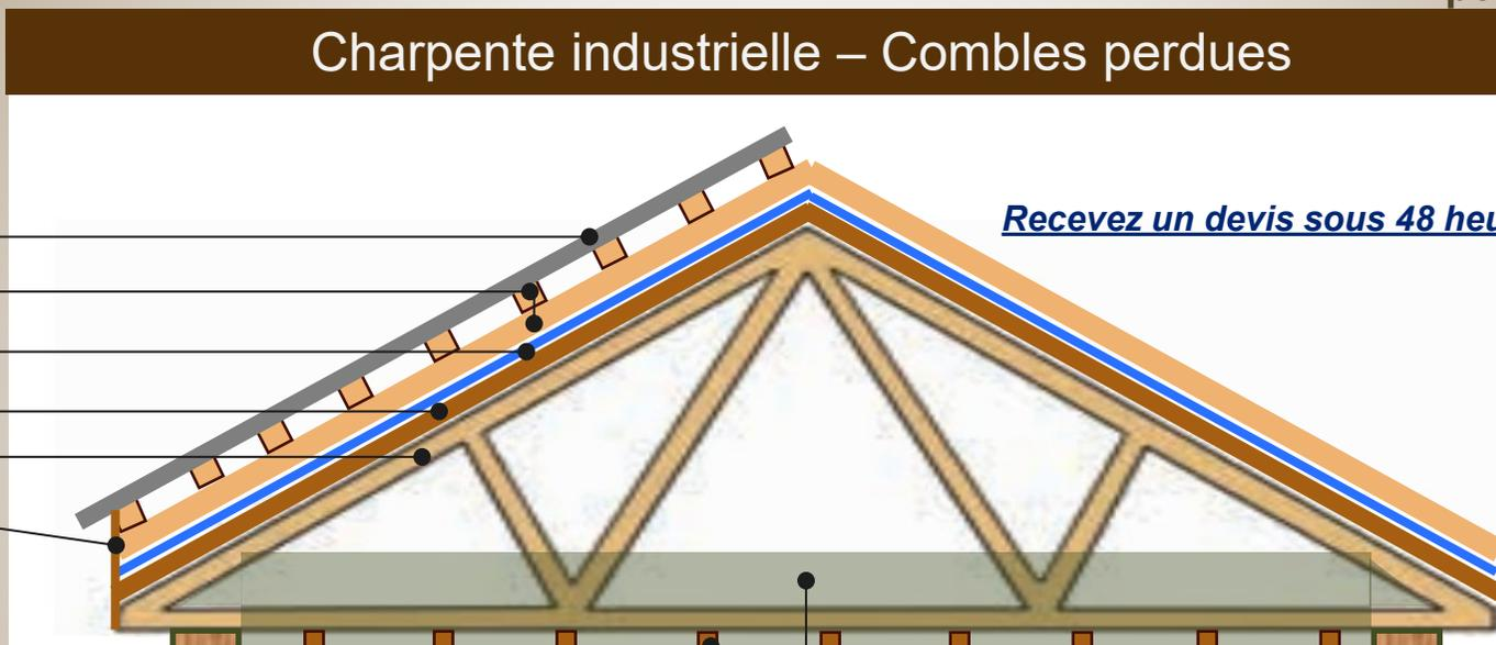
• Grâce à sa technique particulière de triangulation la charpente industrielle se révèle être aussi solide que n'importe quelle autre charpente traditionnelle
